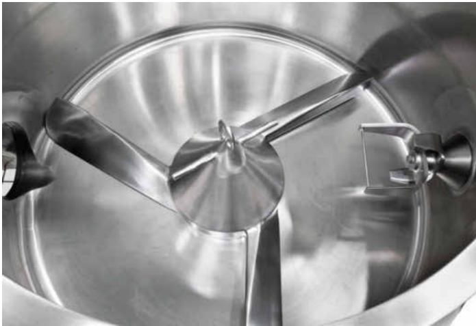
Um ein optimales Mischergebnis zu erzielen und eine schnelle Entleerung zu erreichen, sind die großflächigen Mischflügel dicht über dem Behälterboden am Verdränger im Zentrum angesetzt
