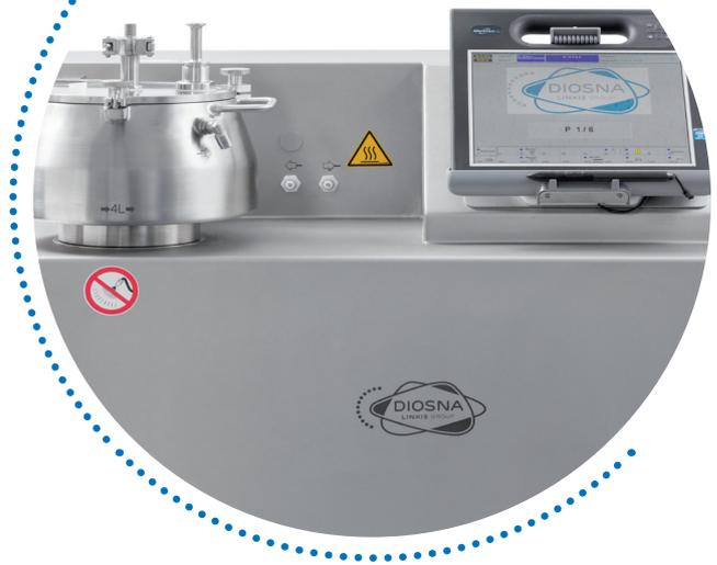
Ein großes Plus an Flexibilität kommt durch die breite Integrationsmöglichkeit weiterer Anlagen hinzu. Der Pharmamischer P 1-6 ergänzt geradezu perfekt das vorgelagerte Mischen. Durch einfachen Tausch von Misch- auf Spheronizer-Behälter sind im Nu gezielt Pellets erzeugt.
